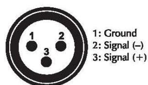
Se você estiver usando controladores com essa função, você pode conectar o DMX saída do controlador DMX diretamente com a entrada do primeiro jogo, no DMX de cadeia. Se você quiser conectar com outros controladores DMX-LR saídas, você precisará usar adaptador de cabos.
